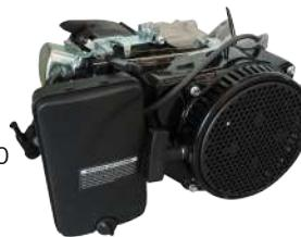
Motor 4 tiempos OHV, 7.5hp, 210 cc, 3600 rpm, arranque eléctrico, eje 19.4 i para generador PWC 4000.
