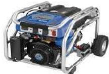
Motor SUBARU EX40 4 tiempos OHV, 14 hp, 220 cc, 7000 w continuos, 8700 w pico, 120-240 v. Capacidad del tanque 15 litros, 10 horas de trabajo continuo, arranque eléctrico, peso 110 kg.
