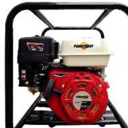
Motor POWERCAT 4 tiempos OHV, 7.5 hp, 270 cc, succión/descarga 3"x3", succión máxima 8 metros, altura máxima 30 metros, caudal máximo 60 m<sup>3</sup>/hr, bomba tragásolidos, autocebante, peso 37 kg.
