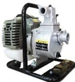
Motor SHIRAIWA 2 tiempos OHV, 1.8 hp, 43 cc, succión/descarga 1"x1", succión máxima 8 metros, altura máxima 30 metros, caudal máximo 10m<sup>3</sup>/hr, peso 12 kg.
