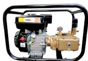
Base tipo estructura, motor POWERCAT 4 tiempos, 6.5 hp, 190 cc. Incluye manguera de 50 metros, 800/1200 rpm, succión 8 metros, sin válvula de alivio, sin bandas, ensamble directo, con sensor de aceite; bomba con pistones de cerámica, peso 35 kg.
