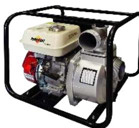
Motor POWERCAT 4 tiempos OHV 6.5/7.5 hp, succión/descarga 2"x2", succión máxima 8 metros, altura máxima 28 metros, caudal máximo 30 m<sup>3</sup>/hr, peso 26 kg.
