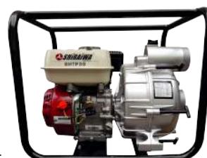
Motor SHIRAIWA 4 tiempos OHV, 7.5 hp, 270 cc, succión/descarga 3"x3", succión máxima 8 metros, altura máxima 30 metros, caudal máximo 60 m<sup>3</sup>/hr, bomba tragásolidos, autocebante, peso 37 kg.
