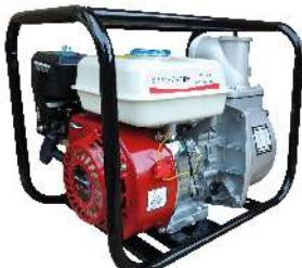
Motor SHIMAH 4 tiempos OHV, 6.5 hp, 196 cc, succión/descarga 3"x3", succión máxima 8 metros, altura máxima 30 metros, caudal máximo 60 m<sup>3</sup>/hr, peso 30 kg.
