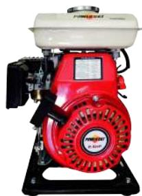
Motor POWERCAT 4 tiempos OHV, 2.5 hp, succión/descarga 1"x1", succión máxima 8 metros, altura máxima 10 metros, caudal máximo 5 m<sup>3</sup>/hr, peso 11 kg.
