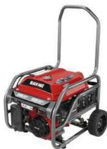
Motor TTI 4 tiempos OHV, 208 cc, motor digital 4 en 1, 3600 w continuos, 4500 w pico, 120 v. Capacidad del tanque 22.7 litros, 10 horas de trabajo continuo, sistema de regulación de voltaje AVR, peso 50 kg.
