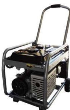
8 kw, motor 4 tiempos OHV, 15 hp, 420 cc, generador 8500 w continuos, 10800 w pico, 110 kg, 220-380 v. Capacidad del tanque 25 litros, 7 horas de trabajo continuo, arranque manual, sistema de regulación de voltaje AVR, peso 104 kg.
