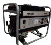
1 kw, motor 4 tiempos OHV, 2.5 hp, 85 cc, generador 800 w continuos, 1200 w pico, 20 kg, 120 v. Capacidad del tanque 10 litros, 5 horas de trabajo continuo, arranque manual, sistema de regulación de voltaje AVR, peso 23 kg.
