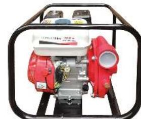
Motor SHIMAH 4 tiempos OHV, 6.5 hp, 196 cc, succión/descarga 2"x2", succión máxima 8 metros, altura máxima 68 metros, caudal máximo 30 m<sup>3</sup>/hr, impulsor de caracol, peso 30 kg.
