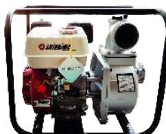
Motor SHIRAIWA 4 tiempos OHV, 13 hp, 430 cc, succión/descarga 4"x4", succión máxima 8 metros, altura máxima 30 metros, caudal máximo 96 m<sup>3</sup>/hr, peso 52 kg.
