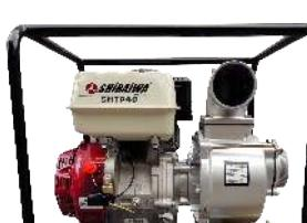
Motor SHIRAIWA 4 tiempos OHV, 15 hp, 430 cc, succión/descarga 4"x4", succión máxima 8 metros, altura máxima 30 metros, caudal máximo 96 m<sup>3</sup>/hr, bomba tragásolidos, autocebante, peso 43 kg.
