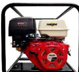
Motor POWERCAT 4 tiempos OHV, 13 hp, 430 cc, succión/descarga 4"x4", succión máxima 8 metros, altura máxima 30 metros, caudal máximo 96 m<sup>3</sup>/hr, peso 52 kg.
