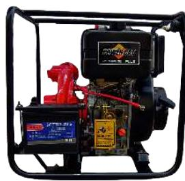
Motor Diesel 4 tiempos, 18 hp, succión/descarga 3"x3", succión máxima 7 metros, altura máxima 85 metros, caudal máximo 45 m<sup>3</sup>/hr, arranque eléctrico, batería incluida, peso 96 kg.
