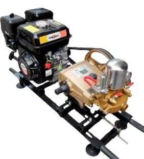
Base tipo camilla, motor POWERCAT 4 tiempos, 6.5 hp, 190 cc. Incluye manguera de 50 metros, 800/1200 rpm, succión 8 metros, con sensor de aceite, bomba con pistones de acero, peso 35kg
