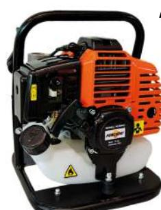
Motor 2 tiempos, 3.6 hp, succión/descarga 1 1/2"x1 1/2", succión máxima 6 metros, altura máxima 28 metros, caudal máximo 24 m<sup>3</sup>/hr, peso 30 kg.
