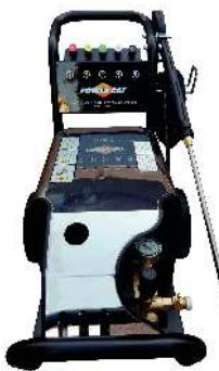
Motor POWERCAT trifásico, 4 hp, flujo máximo 9.5 lpm, presión máxima 3200 psi, voltaje 220v/60hz, 6 metros de manguera de alta presión, cubierta de acero inoxidable, pistola de alta presión, llantas de 10". Incluye 5 boquillas intercambiables, peso 35 kg.
