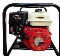
Motor POWERCAT 4 tiempos OHV, 7 hp, 209 cc, succión/descarga 2"x2", succión máxima 8 metros, altura máxima 30 metros, caudal máximo 36 m<sup>3</sup>/hr, bomba para químicos de propileno, autocebante, peso 24 kg.
