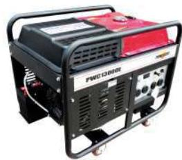
10 kw, motor 4 tiempos OHV, 26 hp, 740 cc, generador 11000 w continuos, 13000 w pico, 120 kg, 120-240 v. Capacidad del tanque 30 litros, 7 horas de trabajo continuo, arranque eléctrico, sistema de regulación de voltaje AVR, peso 174 kg.
