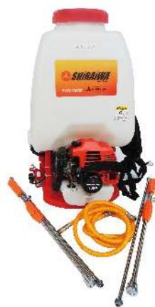
Tipo mochila, motor MITSUBISHI 2 tiempos, 1 hp, 26 cc, capacidad de 25 litros, salida para 2 mangueras. Incluye 2 lanzas de altura y 2 varillas de cama baja con boquilla de rocío, peso 11 kg.
