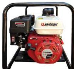
Motor SHIRAIWA 4 tiempos OHV, 7.5 hp, 270 cc, succión/descarga 3"x3", succión máxima 8 metros, altura máxima 30 metros, caudal máximo 60 m<sup>3</sup>/hr, bomba para químicos de propileno, autocebante, peso 28 kg.
