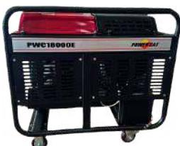
15 kw, motor 4 tiempos, 30 hp, 999 cc, generador de gasolina 60 HZ, 120-240 v. Capacidad de aceite 2.5 litros, capacidad del tanque de gasolina 25 litros, 12 horas de trabajo continuo, arranque eléctrico, sistema AVR.
