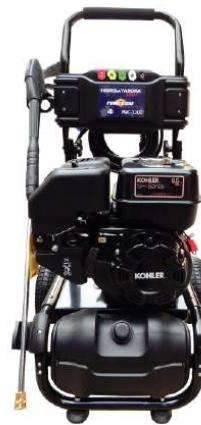
Motor KOHLER, 6.5 hp, 196 cc, presión máxima 3200 psi, caudal máximo 8 lts/min, bomba de bronce ANNOVI, 6 metros de manguera de alta presión, pistola de alta presión, llantas de 10". Incluye 5 boquillas intercambiables y 2 depósitos para detergente, peso 55 kg.
