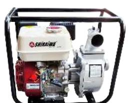
Motor SHIRAIWA 4 tiempos OHV, 6.5/7.5 hp, succión/descarga 2"x2", succión máxima 8 metros, altura máxima 30 metros, caudal máximo 36 m<sup>3</sup>/hr, peso 26 kg.
